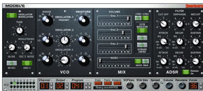
Figura 6.17 Panel del control del sintetizador software Model-E de Steinberg. Se trata de uno de los primeros instrumentos virtuales VST y es la versión virtual de uno de los primeros sintetizadores, el pionero Minimoog. Compárese esta imagen con la de la figura 6.9.
