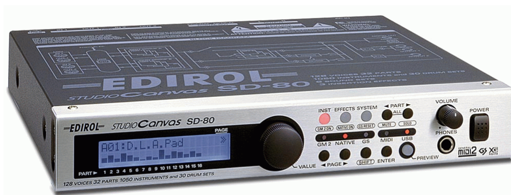
Figura 6.4 Panel de control del módulo de sonido StudioCanvas SD-80 de Edirol. Es más estrecho que la medida convencional de 19 pulgadas pero incorpora unos adaptadores para instalarlo en un 'rack' estándar.
