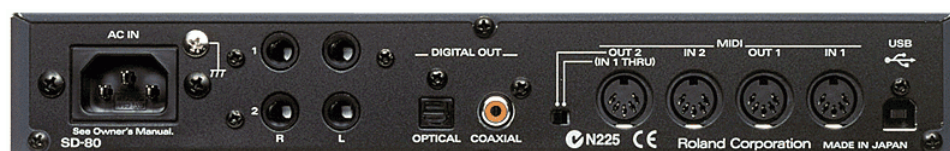
Figura 6.5 Panel trasero del módulo de sonido Edirol SD-80 donde se pueden observar de izquierda a derecha las siguientes conexiones: Alimentación, dos salidas estéreo analógicas, salida digital óptica y coaxial (eléctrica), 2ª salida MIDI (o MIDI 1 Thru configurable), Entrada MIDI 2, Salida MIDI 1, entrada MIDI 1 y conexión USB 2.0.
