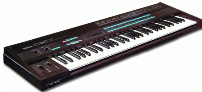
Figura 6.10 Primer sintetizador digital de amplia difusión que empleó el método de la modulación en frecuencia (FM), el Yamaha DX7.
